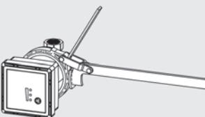
Überwurfmutter mit  $30 \text{ Nm}$  Drehmoment festziehen.
