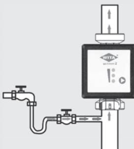
Vor Inbetriebnahme der Pumpe ist die Anlage gründlich zu spülen, damit keine Verunreinigungen oder Fremdkörper in der Anlage verbleiben. Anlage sachgerecht füllen und entlüften. Eine unvollständige Entlüftung führt zu Geräuschenentwicklung in der Pumpe und Anlage.
