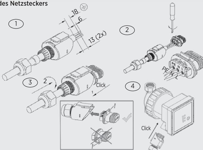
Schließen Sie das Netzkabel wie dargestellt an die Pumpe an. **Vorsicht Netzspannung!** Unbedingt die erforderlichen Schutz- Maßnahmen, VDE-Vorschriften und örtlichen Bestimmungen beachten. Der Leiterquerschnitt darf nicht kleiner als  $0,75 \text{ mm}^2$  sein. Bei Verwendung von feindrähtigen Leitungen sind Aderendhülsen zu benutzen.
