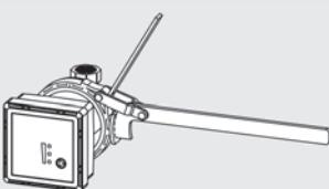
Dokręcić nakrętkę kołpakową momentem obrotowym 30 Nm.
