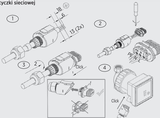
Podłączyć przewód zasilający do pompy w sposób pokazany na rysunku. **Uwaga napięcie sieciowe!** Należy zawsze przestrzegać niezbędnych środków bezpieczeństwa, przepisów VDE i przepisów lokalnych. Przekrój przewodu nie może być mniejszy niż 0,75 mm<sup>2</sup>. W przypadku stosowania kabli o drobnych żyłach należy stosować tuleje końcówek żył.
