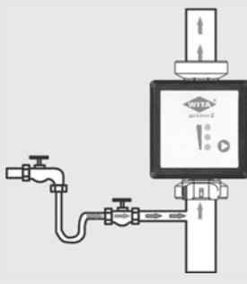
Przed uruchomieniem pompy należy dokładnie przepłukać układ, aby upewnić się, że w instalacji nie pozostały żadne zanieczyszczenia ani ciała obce. Prawidłowo napełnić i odpowietrzyć instalację. Niepełne odpowietrzenie spowoduje hałas w pompie i instalacji.
